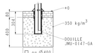
Scellement universel dans douille
