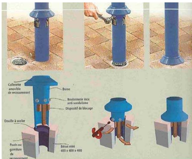
Scellement universel avec système à clé
